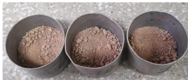
Pesaram-se as cápsulas e o conjunto cápsula e solo previamente e o conjunto foi levado a estufa à temperatura de 105°C até constância de massa. Depois, o conjunto é pesado, a massa seca é registrada e calcula-se o teor de acordo com a Equação (1).
