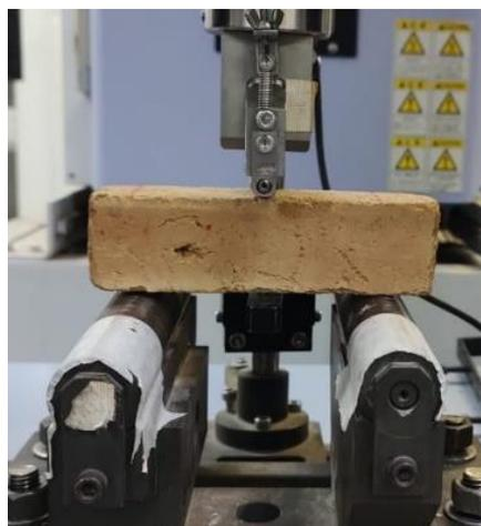
Para o cálculo da resistência a flexão, utilizou-se a Equação (2), de acordo com o trabalho de Araya-letelier *et al.* (2019).
