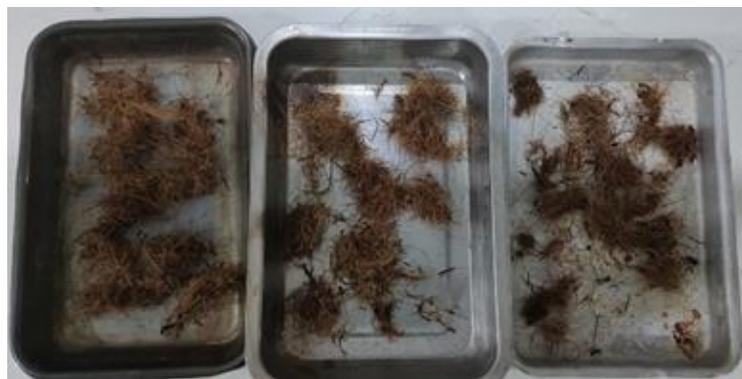
A massa específica, baseou-se na NBR 52/2009, onde inicialmente as fibras ficaram submersas em água por 24h, em seguida foram expostas ao ar para secar superficialmente e dispostas em frascos com água até a marca de 500ml (Figura 17), os frascos ficaram em repouso em um banho de 21°C durante 1 hora, completou-se de água os frascos e o conjunto foram pesados e registrou-se a massa total. Por fim as amostras foram retiradas e colocadas em estufas para secar a 105°C até constância de massa.
