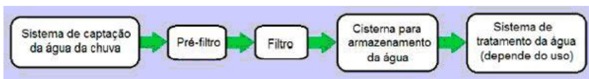
Figura 3 - Componentes do sistema de filtração da água da chuva para dessedentação animal. Fonte: EMBRAPA, 2012.
