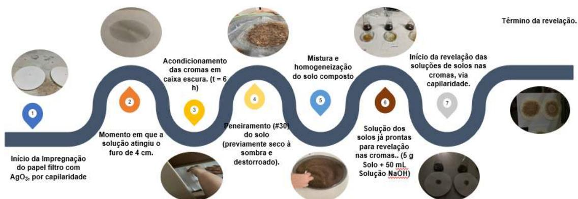
**Figura 07:** Passo a passo da preparação dos cromatogramas.
